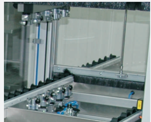
Rotierende Reinigungsdüsen in einer Durchlaufreinigungsanlage. Angeordnet von oben und unten für eine beidseitige Reinigung und Entladung.
